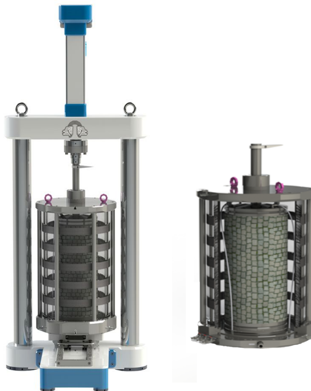
Рис. 2. Установка трехосного сжатия D300' 600 ГТ 1.3.7 для испытания крупнообломочных грунтов
