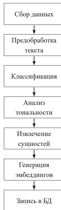
Рис. 1. Схема работы конвейера обработки и анализа текста
