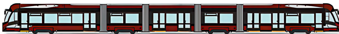
Рис. 1. Российский пятизвенный двухсторонний трамвайный вагон модели 71-952 «Воевода» длиной 37,5 м и вместимостью до 400 чел. [5].
