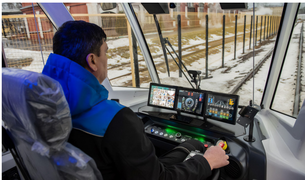
Рис. 4. Кабина водителя трамвая модели 71-932 «Невский», оснащенная системой обеспечения активной безопасности и помощи водителю Cognitive Tram Pilot [15].
