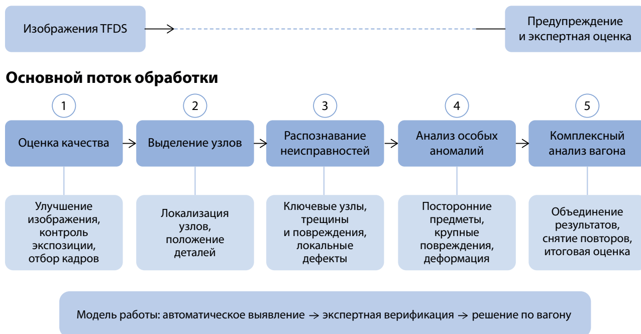
Рис. 2. Схема процесса интеллектуального распознавания неисправностей в системе TFDS
