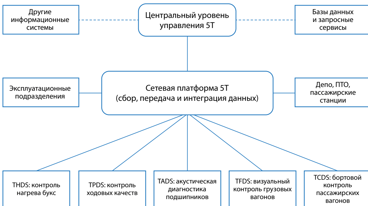
Рис. 1. Структурная схема системы мониторинга безопасности эксплуатации подвижного состава 5Т
