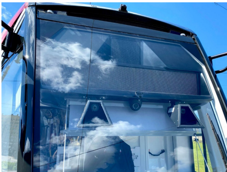
Рис. 2. Кабина трамвая, оснащенная системой Cognitive Tram Pilot: два блока видеокамер расположены под софитами [15]. Источник: Cognitive Tram Pilot
