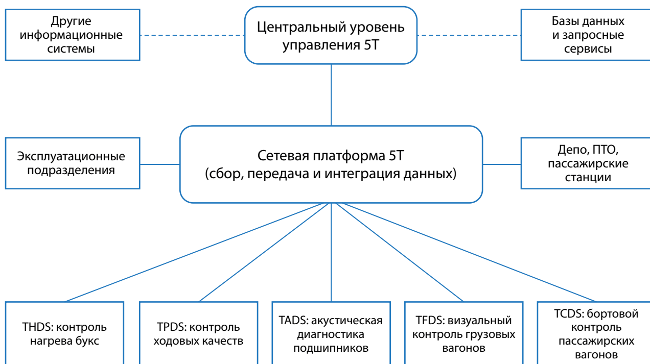
Рис. 1. Структурная схема системы мониторинга безопасности эксплуатации подвижного состава 5T
