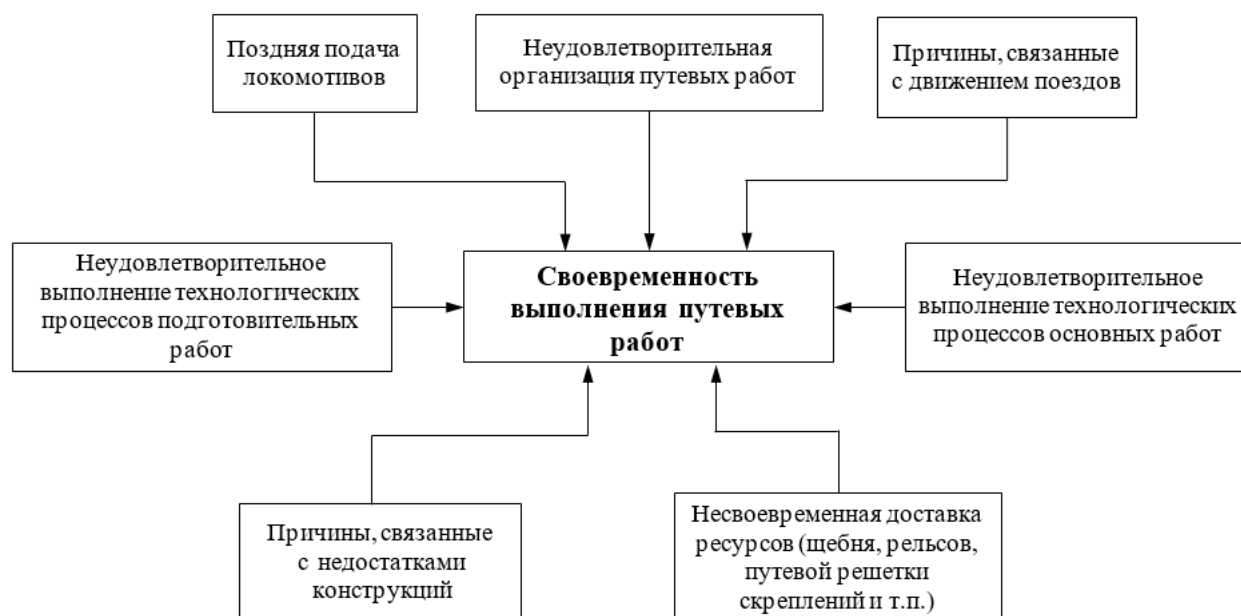
Рис. 2. Схема факторов, влияющих на своевременность выполнения путевых работ
