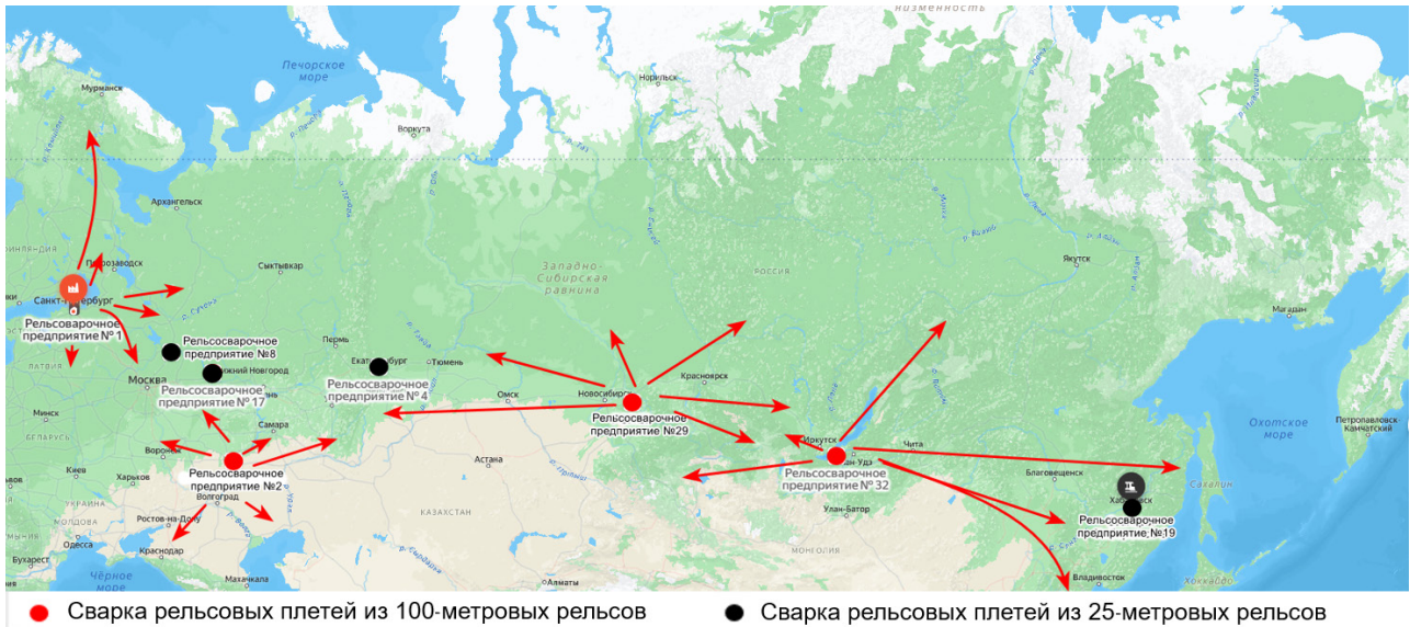
Рис. 4. Схема поставки рельсовых плетей на сети железных дорог РФ
