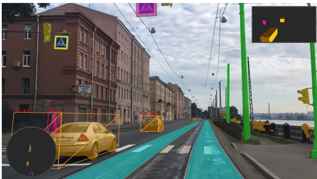
Рис. 3. Интерфейс системы компьютерного зрения [8]. Источник: Cognitive Tram Pilot
