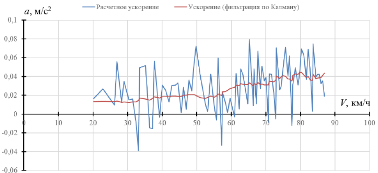
Рис. 1. Экспериментальная запись ускорения и ее вид после фильтрации алгоритмом Калмана 2-го порядка [14]
