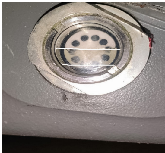
Рис. 7. Маслоуказательное окно и масломерная линейка модифицированного кожуха зубчатой передачи (фото Д. А. Колотай)
