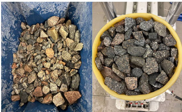
Рис. 3. Сборка образца из чистого щебня
