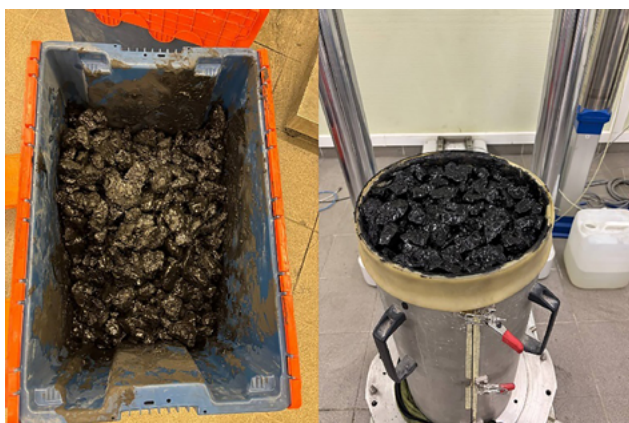
Рис. 4. Сборка образца из загрязненного щебня угольной пылью
