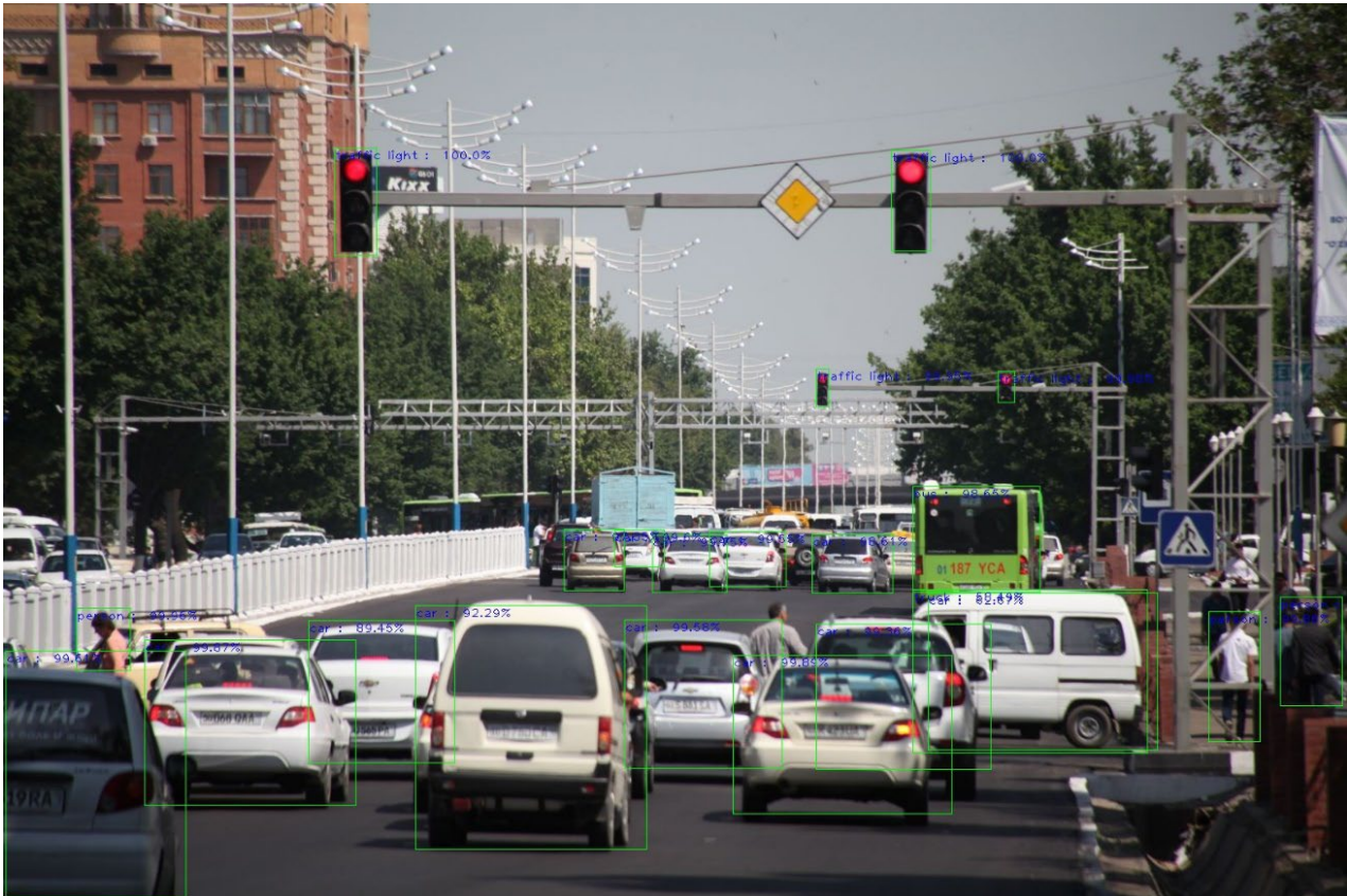
Рис. 4. Результат распознавания объектов на основе модели YOLO
