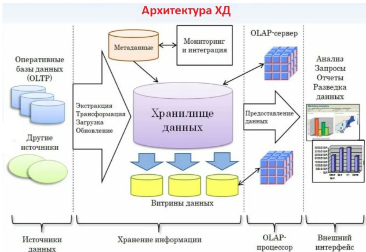
Рис. 1. Схема архитектуры объектного хранилища данных
