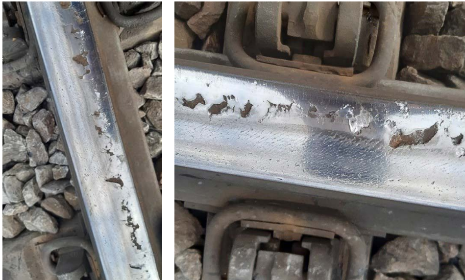
Рис. 6. Трещины и выкашивания на поверхности катания внутреннего рельса в кривой радиусом 600 м (код 11)
