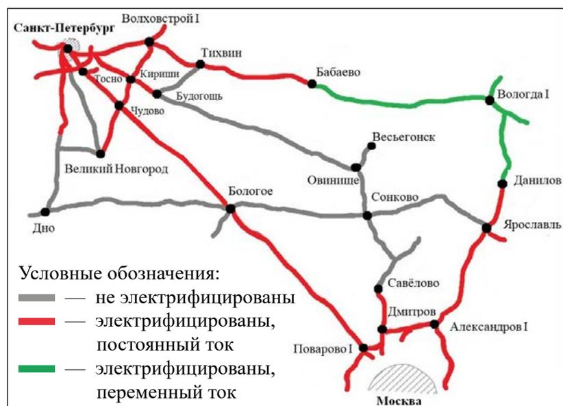
Рис. 1. Схема грузопотока в обход главного хода Октябрьской железной дороги [1–2]
