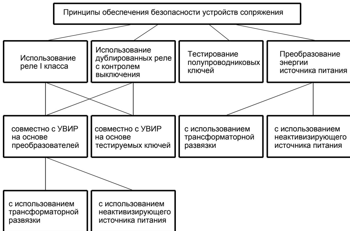
Рис. 1. Классификация УСО по принципам обеспечения безопасности
