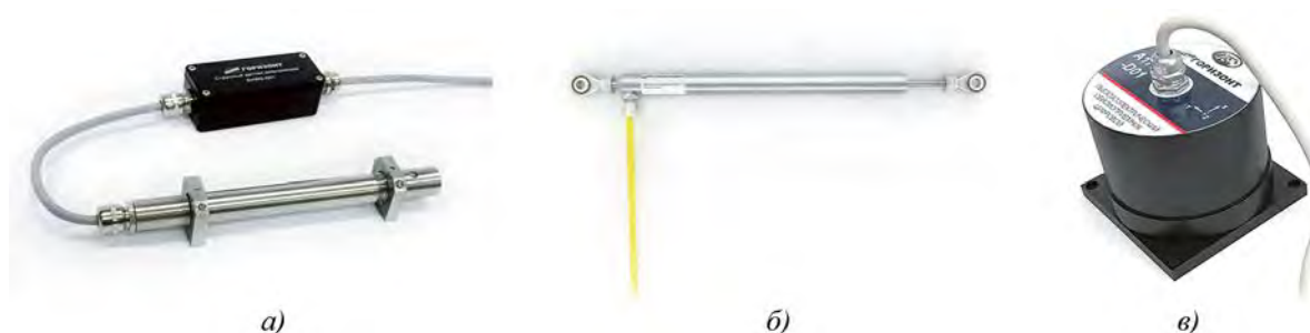
Рис. 2. Измерительное оборудование, использованное при проведении экспериментальных исследований: а) датчик относительных деформаций; б) индукционный датчик перемещений; в) трехосный акселерометр. Фотографии предоставлены автором
