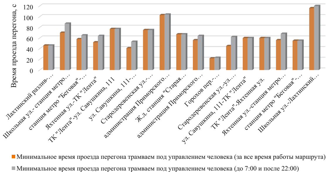
Рис. 5. Сравнение минимальных времен проезда перегонов по маршруту № 19 трамваем, под управлением водителя, в различное время работы маршрута
