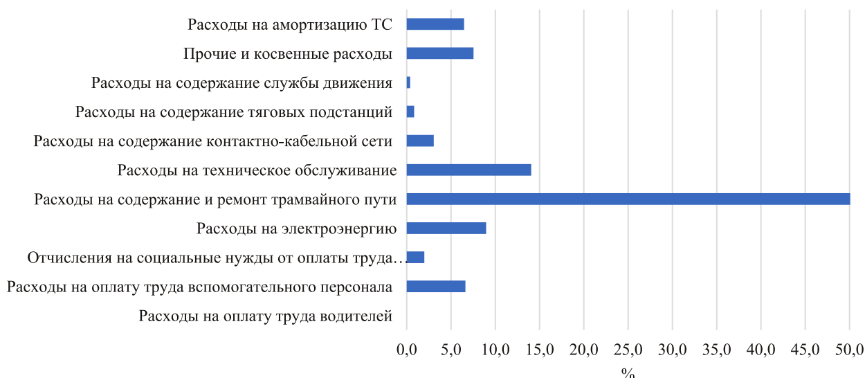
Рис. 8. Структура эксплуатационных затрат для Сценария 3 (работают 2 трамвая, отсутствует статья затрат на оплату труда водителей, но сохранена статья затрат на оплату труда вспомогательного персонала)
