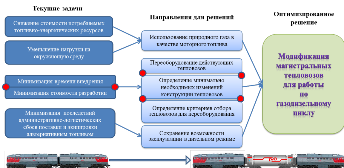
Рис. 1. Решение задач снижения экологической нагрузки, эксплуатационных расходов и минимизации сопутствующих затрат тепловозов
