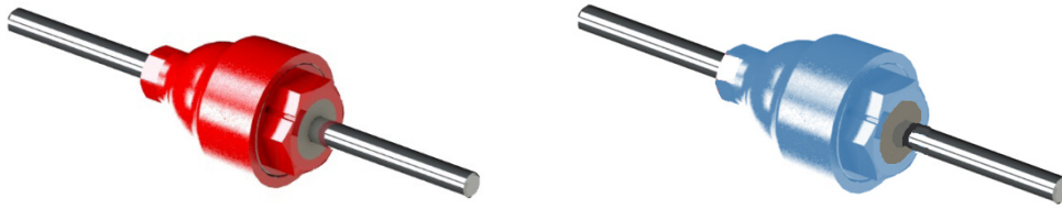
Рис. 4. Принцип работы индикации модернизированного ИП
