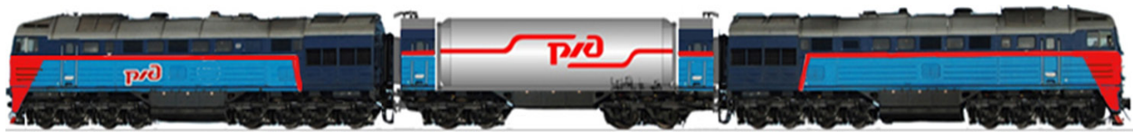
Рис. 2. Общий вид магистрального газотепловоза
