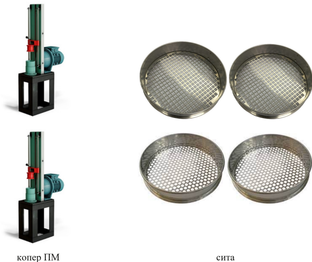
Рис. 4. Перечень оборудования, применяемого при испытаниях щебня на сопротивление удару на копре
