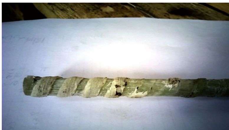
Рис. 1. Срез навивки на испытанном образце
