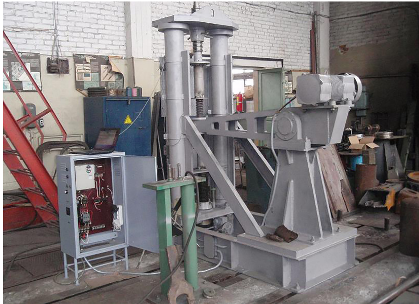
Рис. 6. Общий вид стенда для усталостных испытаний пружин
