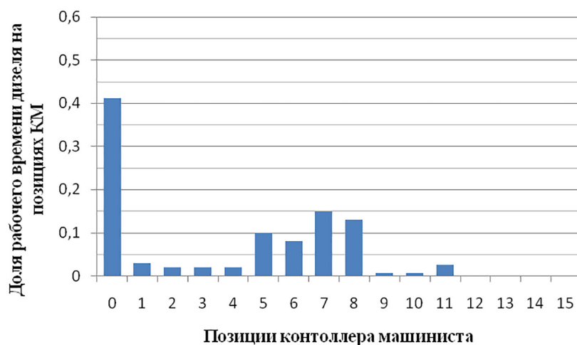
Рис. 1. Распределение рабочего времени дизеля по позициям КМ
