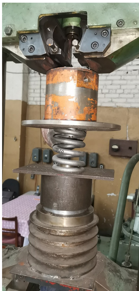
Рис. 2. Общий вид статических испытаний пружин на универсальной испытательной машине ЦДМ Пу 10
