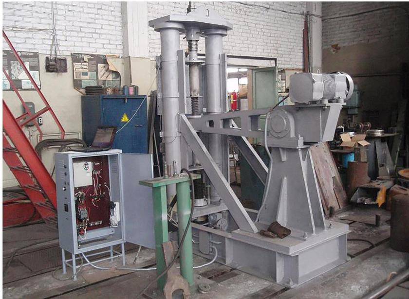
Рис. 6. Общий вид стенда для усталостных испытаний пружин
