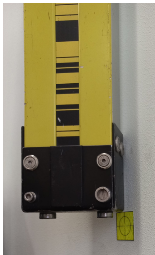
Рис. 3 Установка рейки на ребро пленочного отражателя
