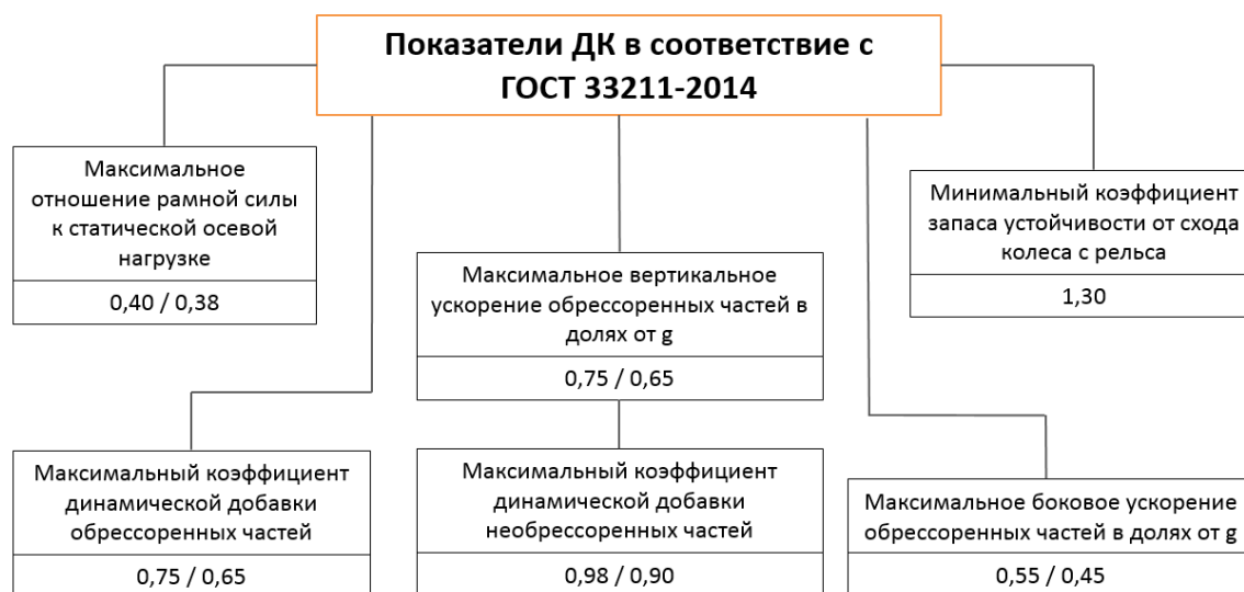
Рис. 2. Показатели динамических качеств вагона и их допускаемые значения в РФ (в числителе для вагона с минимальной расчетной массой, в знаменателе — с максимальной)
