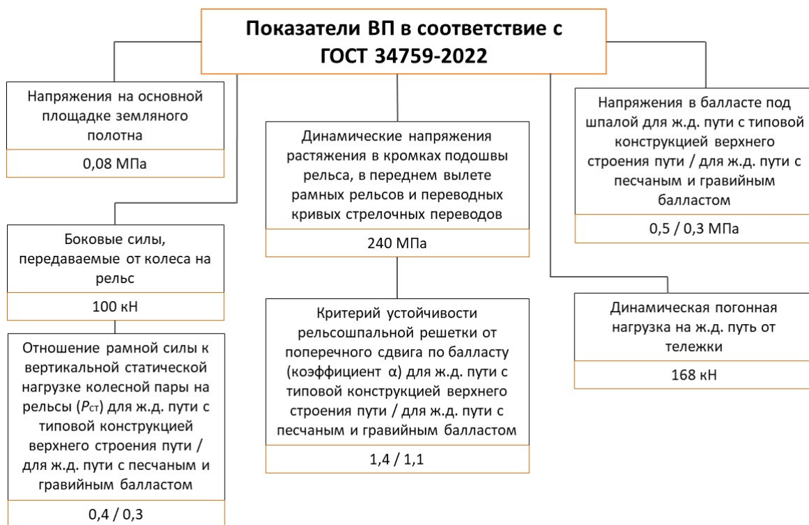
Рис. 3. Показатели воздействия на путь, их допускаемые значения в РФ
