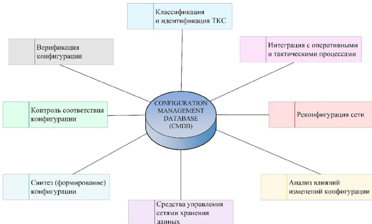
Рис. 2. Архитектура конфигурационной базы данных (CMDB)
