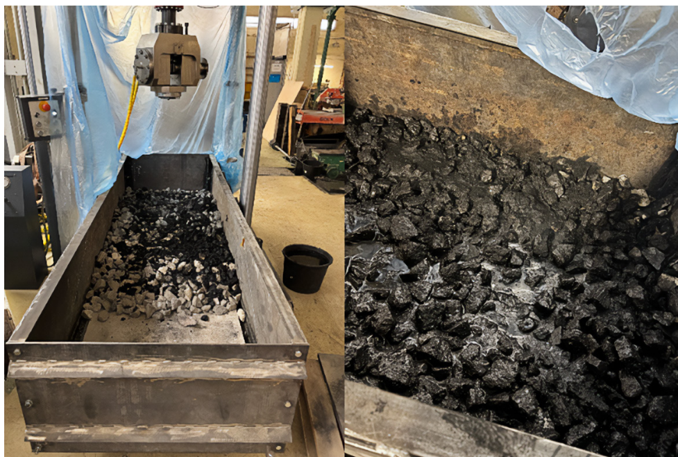
Рис. 3. Послойная отсыпка загрязненного щебня с увлажнением
