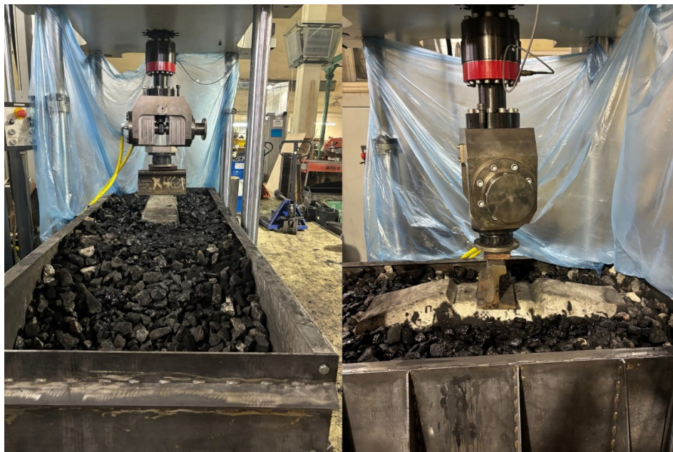
Рис. 4. Сформированная конструкция загрязненной балластной призмы для проведения испытания
