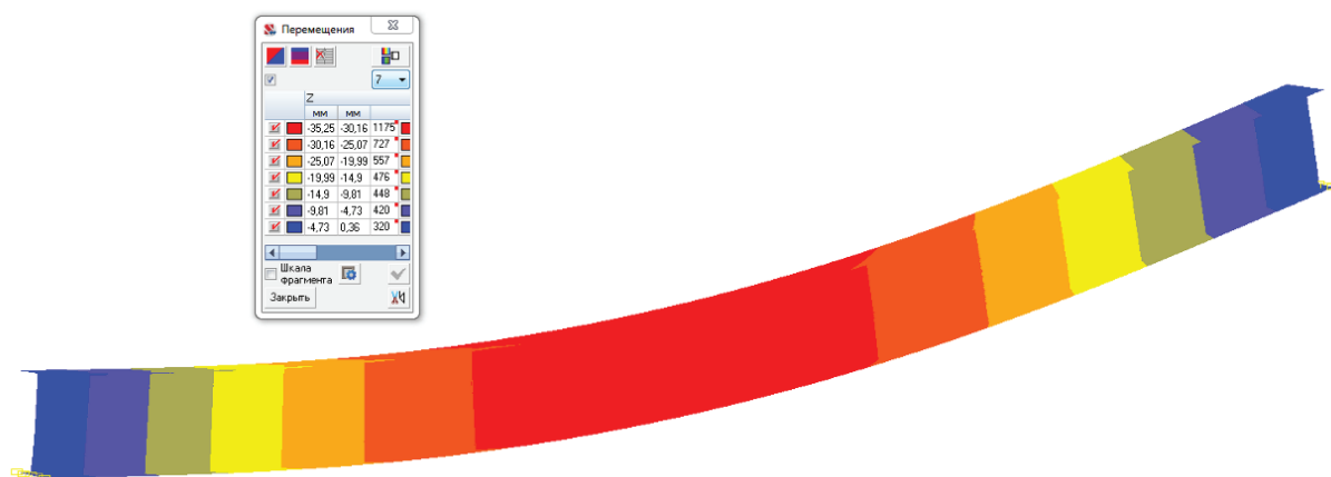
Рис. 3. Деформированная схема балки, мм
