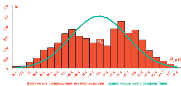
Рис. 1. Гистограмма частот \omega распределения вертикальных сил на внутреннюю рельсовую нить кривого участка пути и кривая нормального распределения (цистерны)
