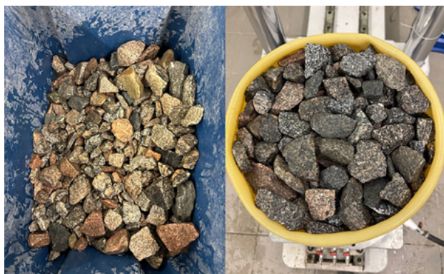
Рис. 3. Сборка образца из чистого щебня
