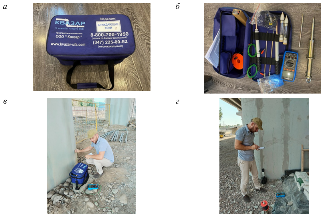
Рис. 4. Натурный поиск и измерения характеристик блуждающего тока (автор: А. А. Белый): а, б — набор «Блуждающие токи»; в, z — процесс натурных измерений
