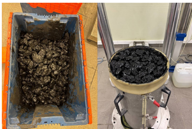
Рис. 4. Сборка образца из загрязненного щебня угольной пылью
