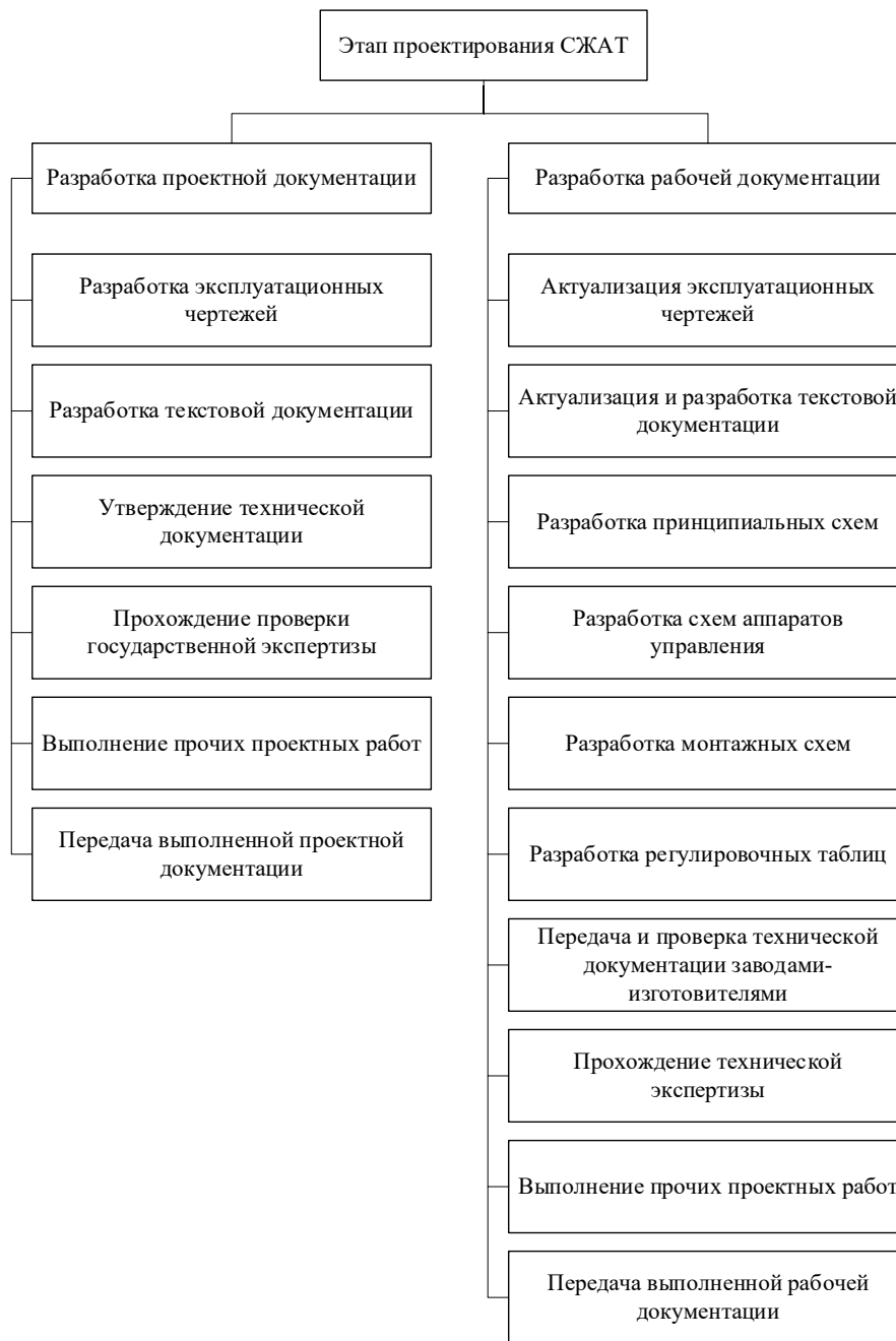
Рис. 2. Структура этапа проектирования СЖАТ
