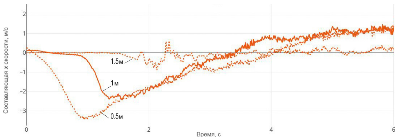
Рис. 7. Эпюры скоростей потока для конфигурации модели 2 (с эстакадой)
