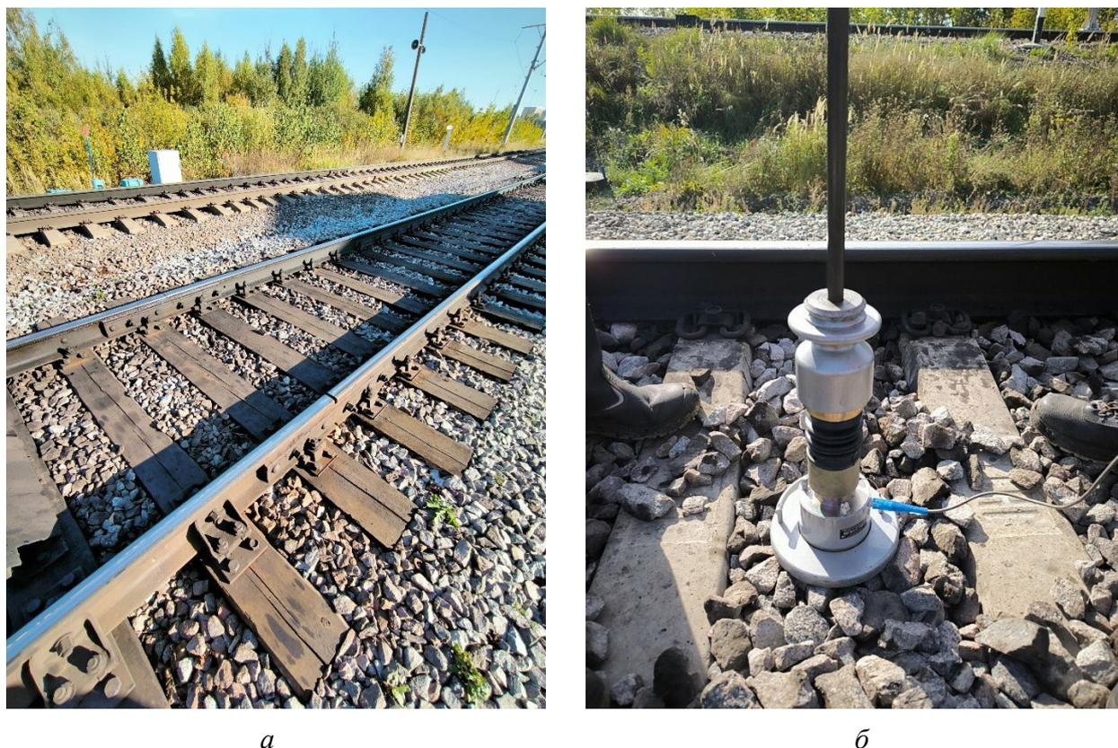
Рис. 4. Измерение модуля деформации (фото авторов):
