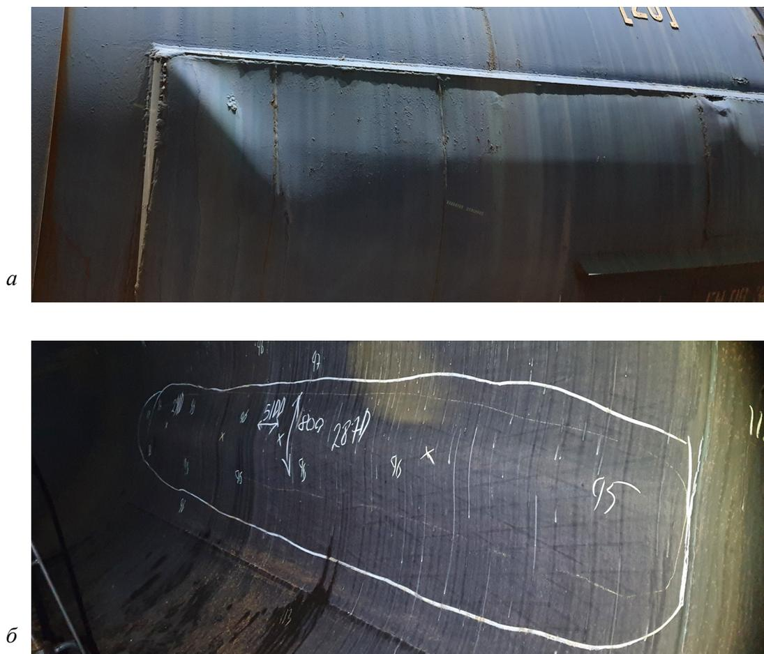
Рис. 1. Вмятина обечайки котла в зоне паровой рубашки вследствие потери устойчивости: *а* — вид вмятины снаружи (паровая рубашка демонтирована);
