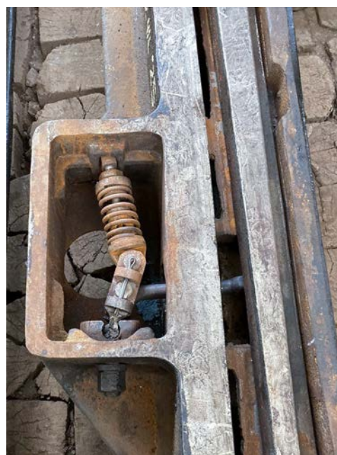
Рис. 6. Механический замыкатель трамвайной стрелки (фото О. В. Вострикова)
