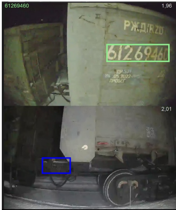
Рис. 2. Пример распознанных объектов в кадрах видеокамер СТУ
