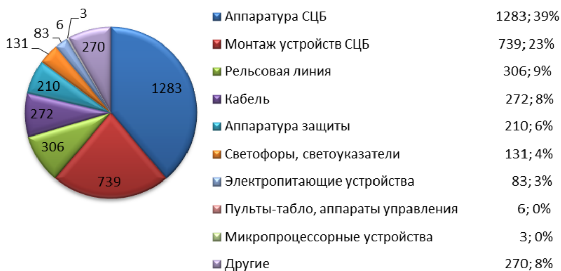
Рис. 3. Диаграмма распределения отказов систем АБ с децентрализованным размещением аппаратуры по хозяйству Ш по элементам
