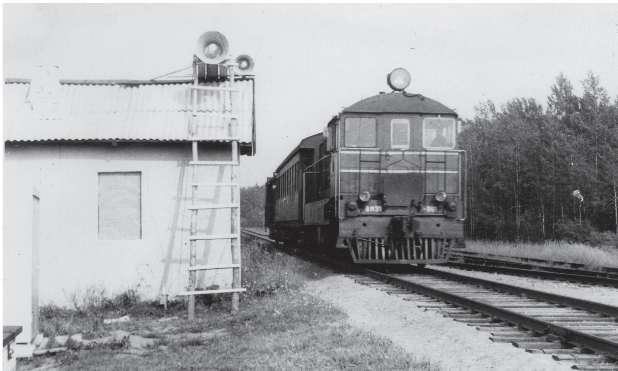
Рис. 2. Расположение излучателя звука при эксперименте
