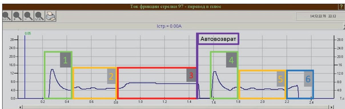
Рис. 7. Токи фрикции при переводе горочной стрелки и непрохождении контроля
