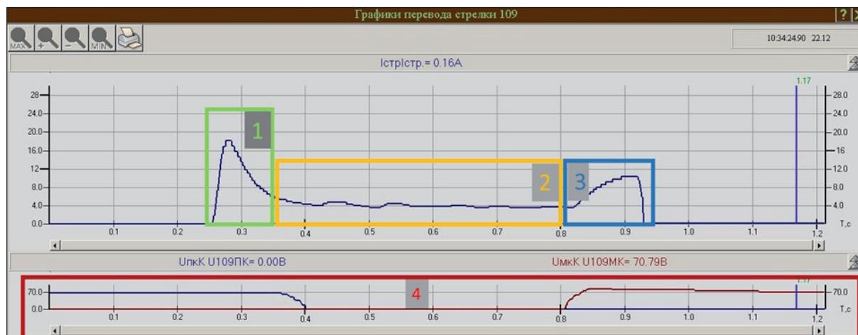
Рис. 6. Точный график работы электродвигателя при переводе стрелки
