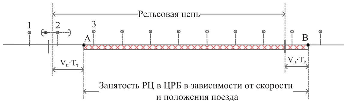
Рис. 5. Расчет времени t_{\text{РЦ}} - t_{\text{борт}}
