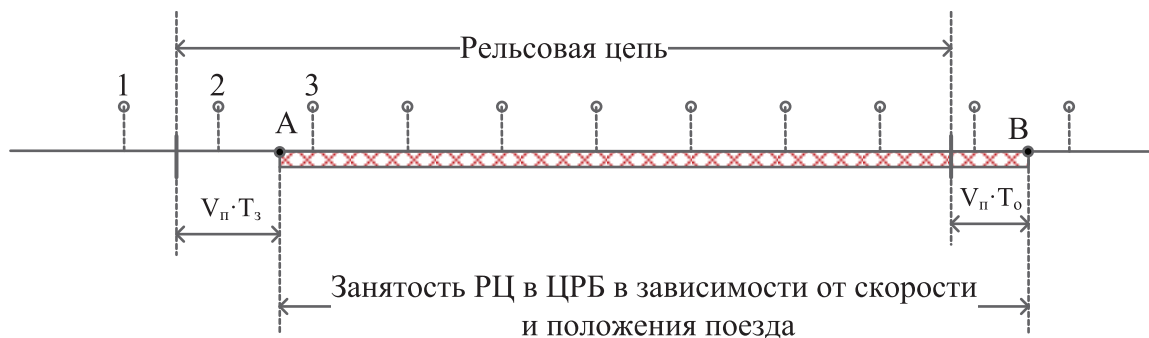
Рис. 4. Представление координат в центре радиоблокировки с учетом скорости и положения поезда
