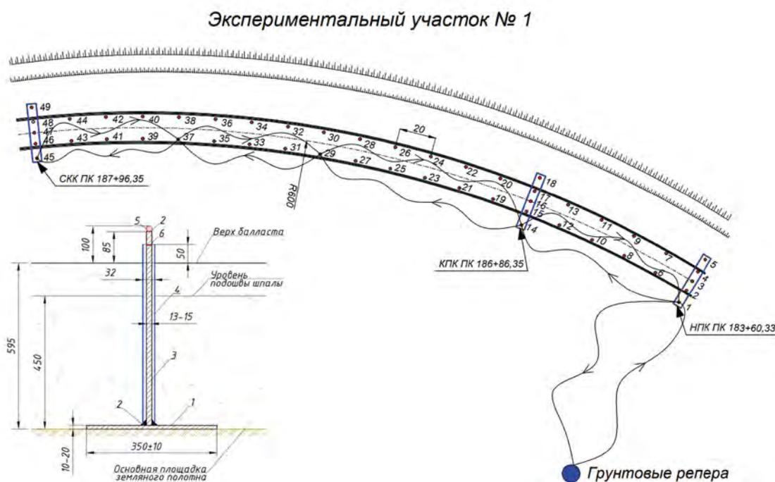
**Рис. 1.** Схема расположения грунтовых деформационных марок и опорных реперов на экспериментальном участке
