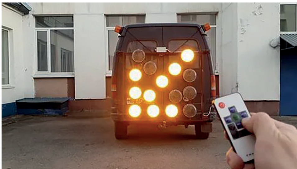
Рис. 1. Пример применения дорожной системы световой индикации на автомобиле
