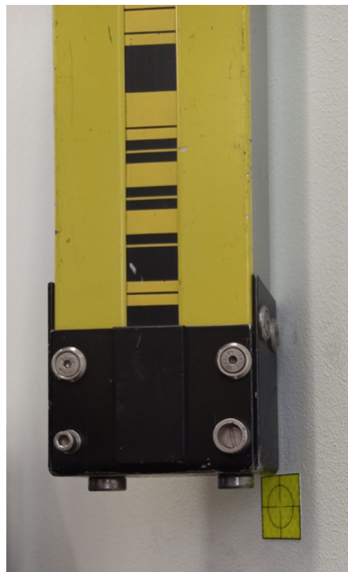
Рис. 3 Установка рейки на ребро пленочного отражателя
