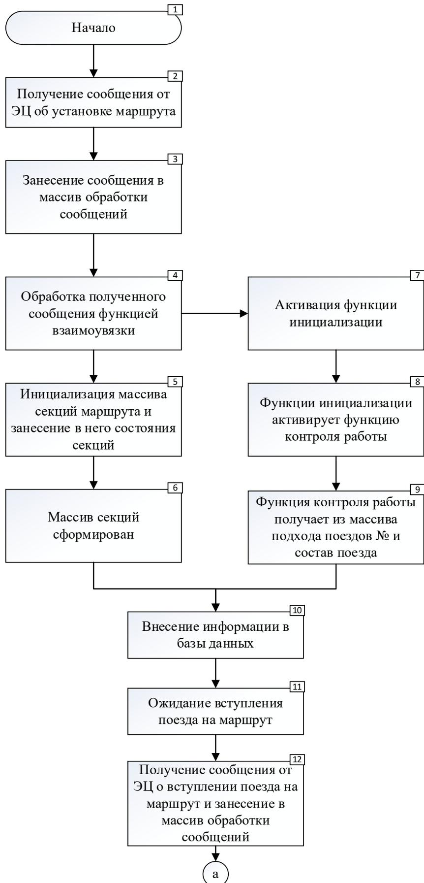
Рис. 3.1. Алгоритм контроля передвижений (начало)
