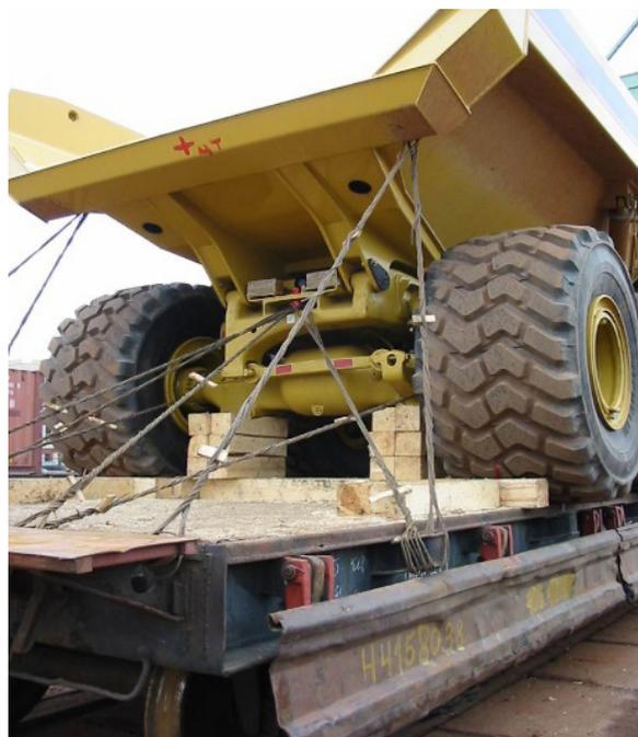
Рис. 1. Размещение и крепление колесной техники на платформе
