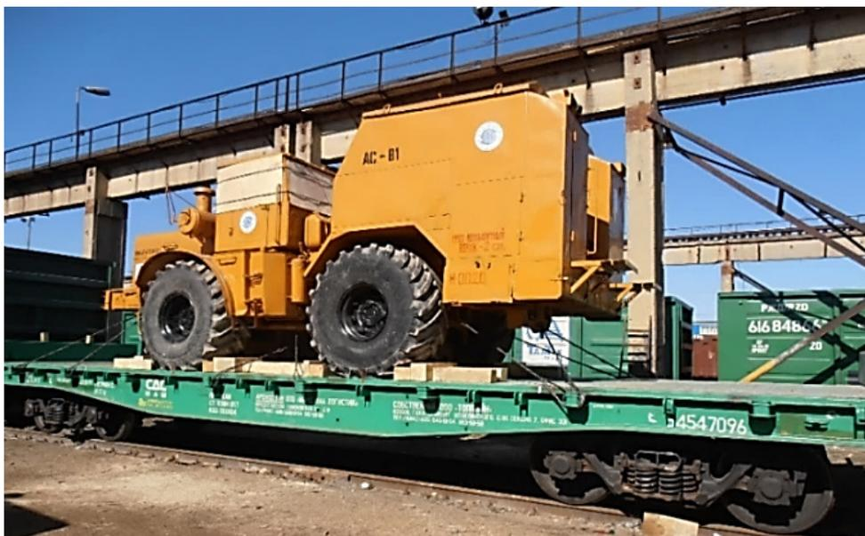
Рис. 7. Размещение сварочного агрегата АС-81 на ж. д. платформе
