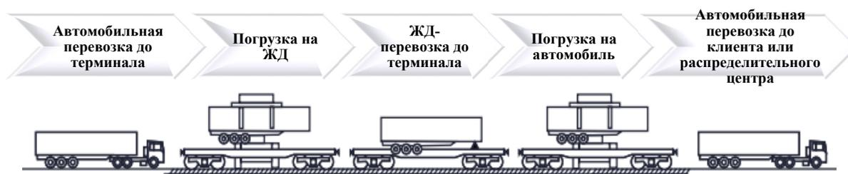
Рис. 7. Порядок организации контрейлерной перевозки
