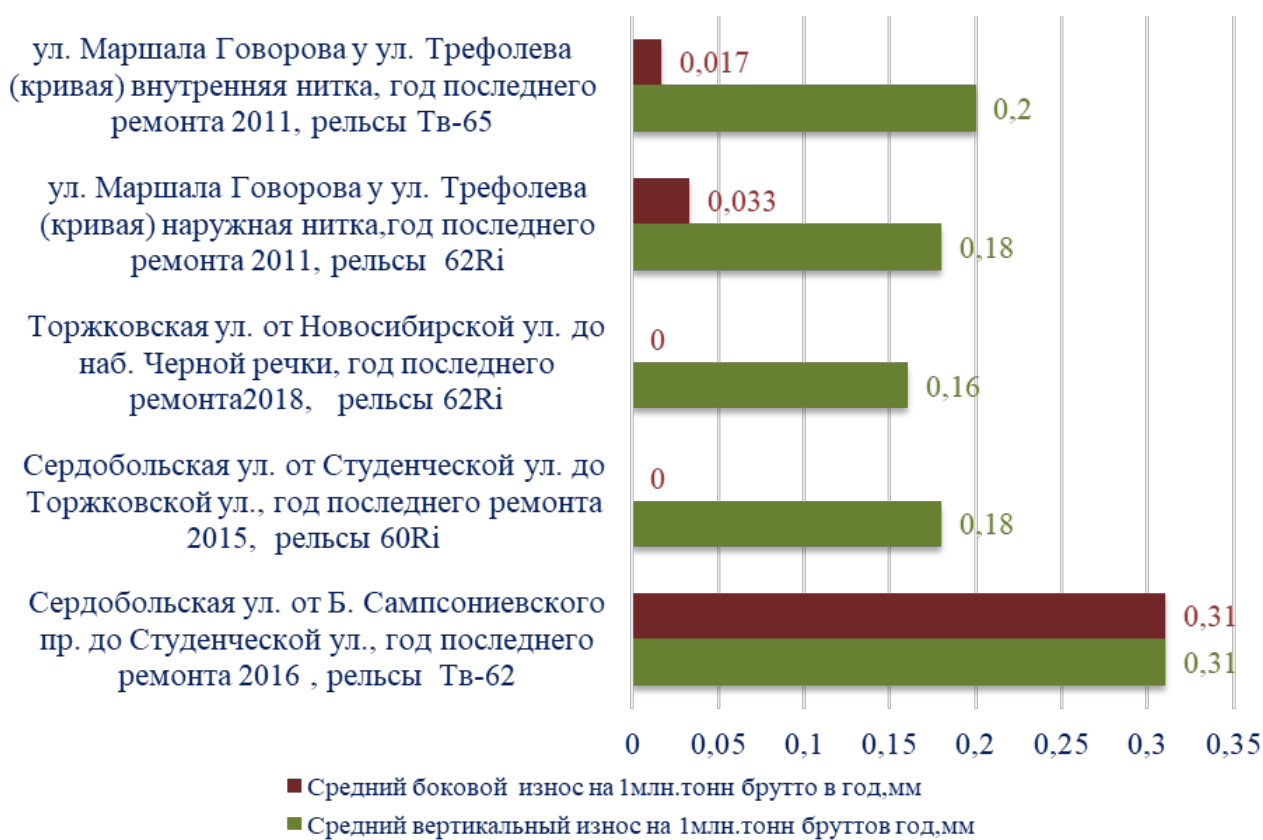
Рис. 3. Интенсивность износа трамвайных рельсов на 1 млн тонн брутто в год
