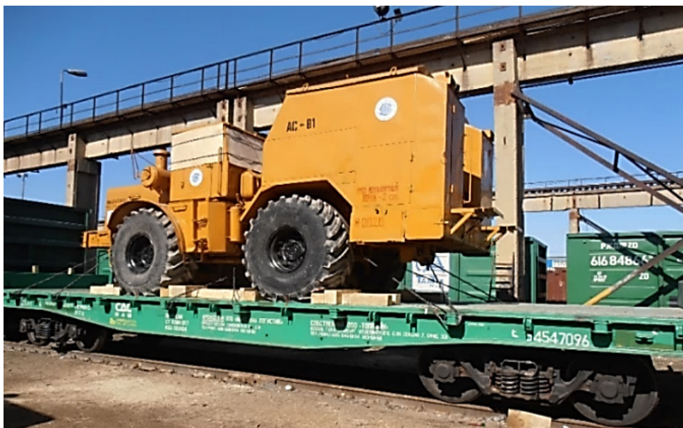
Рис. 7. Размещение сварочного агрегата АС-81 на ж. д. платформе
