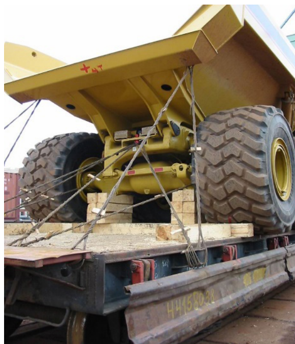
Рис. 1. Размещение и крепление колесной техники на платформе
