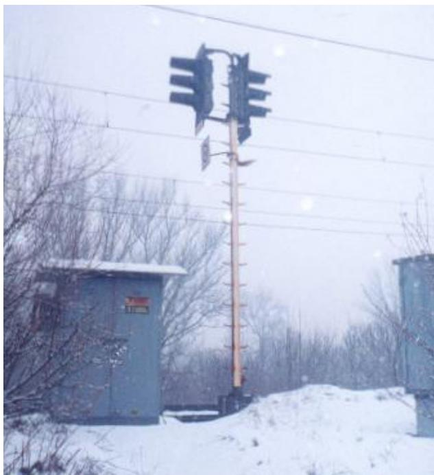
Рис. 8. Совмещенные блок-сигналы на двухпутном перегоне Жилина — Врутки в Словакии
