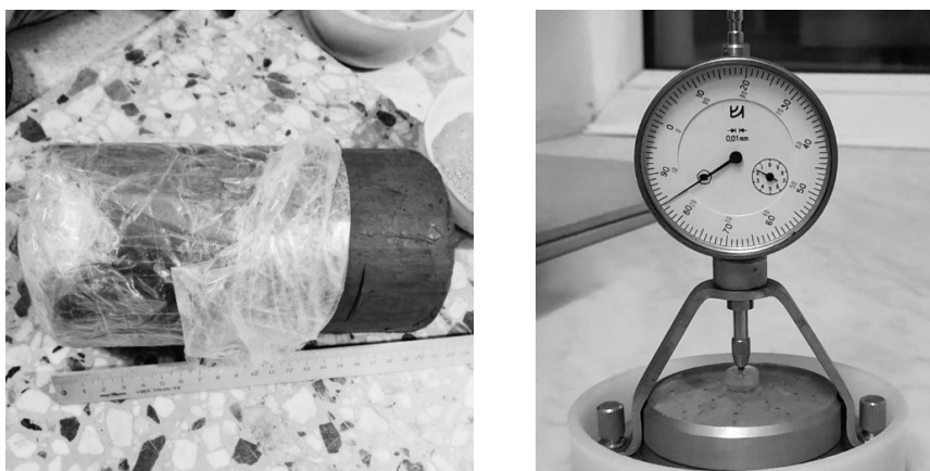
Рис. 2. Образец синей глины и его испытание на ПНГ-2
