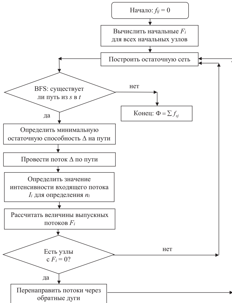
Рис. 2. Алгоритм итеративной процедуры, обобщающей алгоритм Форда — Фалкерсона (в реализации Эдмондса — Карпа) с нелинейными MFD-ограничениями
