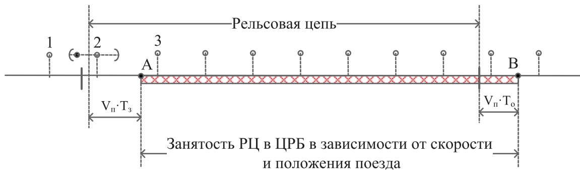
Рис. 5. Расчет времени t_{\text{РЦ}} - t_{\text{борт}}
