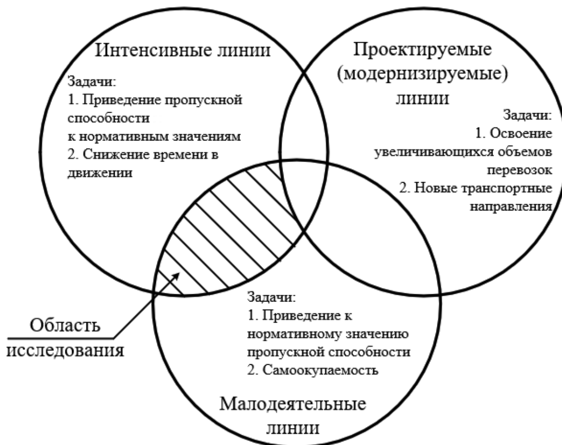
Рис. 2. Схема структурного синтеза при взаимодействии проектируемых, интенсивных и малодеятельных железнодорожных линий
