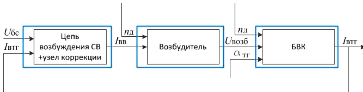
Рис. 2. Пример декомпозиции узла возбуждения тягового генератора тепловоза в соответствии с концепцией функционально прозрачных нейронных сетей: U_{бс} – напряжение бортовой сети; I_{втг} – ток возбуждения тягового генератора; I_{вв} – ток возбуждения возбудителя; напряжение возбудителя; n_d – частота вращения коленчатого вала дизеля; БВК – управляемый выпрямитель; \alpha_{тг} – угол управления тиристорами
